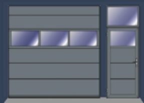
Alignement sur porte sectionnelle à section vitrée
