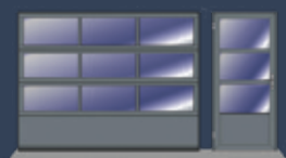
Alignement sur porte sectionnelle vitrée à section inférieure pleine.
